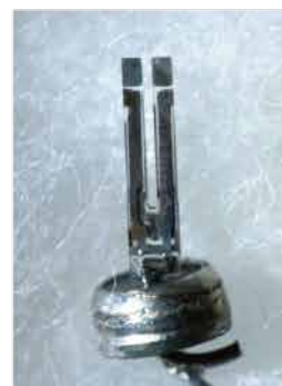
腕時計の中の水晶振動子
