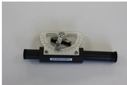
ハンドレベル：数量5 使用例：身の回りの植生調査、川原の石や地形の調査など
